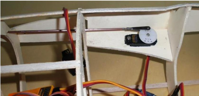
Quand la profondeur descend, les plans canard montent, (débattement +5 mm et - 5mm)
